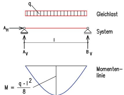
$ql^2/8$  ist das maximale Biegemoment an einem einfachen Balken unter gleichmässig verteilter Belastung. Mehr dazu in den Vorlesungen Mechanik und Baustatik im 3. Semester.
